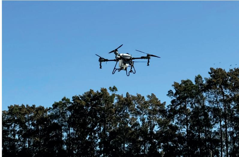
competitivo democratiza el acceso a esta tecnología. Con capacidad de carga de hasta 40 kilos y 40 litros, estos drones ofrecen autonomía de vuelo y sistemas inteligentes para realizar siembras de cobertura, pulverizaciones
